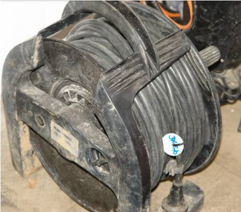
RFID-Chip (runde weiße Plakette) an einer Kabeltrommel.
